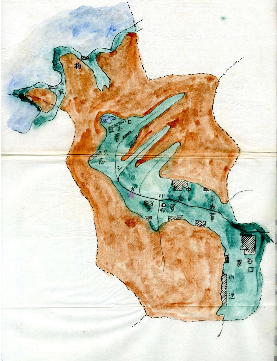
比井崎村小坂峠を越へて本村に入りて、中志賀・下志賀・谷口を経て和田村に入る。本村として最も重要な路線である。此の縣道は明治十七年幅員二・七米余に改修したのを、大正十三年に至り幅員四・五米余に改修する爲に着手し、昭和二年に漸く完成したのである。此の改修に依つて本村小幸校北側を通過してゐた路線は南側へ変更したのである。此の延長は約四・九米である。
